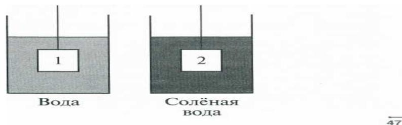
$G_{\text{выт}}$  определяется как разность веса тела в воздухе и в жидкости. Сначала полностью опускаем тело, подвешенное к динамометру, в пресную воду, а затем в солёную. Показания динамометра в солёной воде меньше. Вывод: выталкивающая сила зависит от плотности жидкости.
